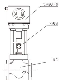
图3 安装示意
